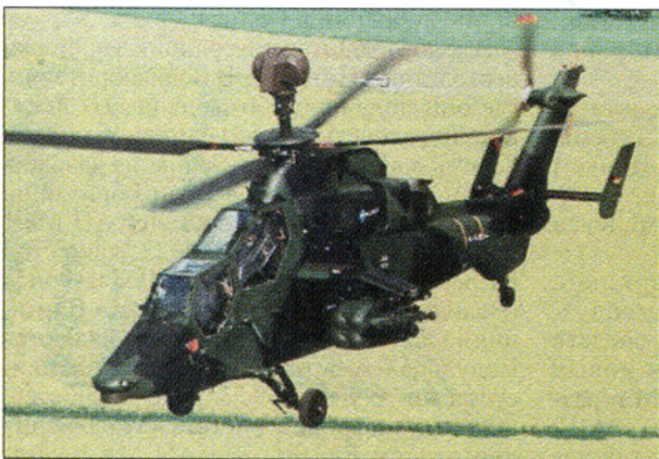
Рис. 4. Ударный вертолет «Тигр» в варианте УНТ (с ПТУР «Тригат») для СВ ФРГ
